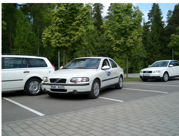
Figur 2 Till vänster Evolve-projektets plattform från Volvo med elektriskt styrservo genomför autonom parkering med hjälp av ultraljudssensorer. Till höger test rigg för "Active-pinion" servostyrning.
